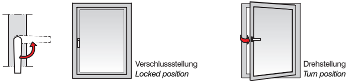
Abb.5: Bedienung von Drehfenstern Fig.5: Turn windows operation
